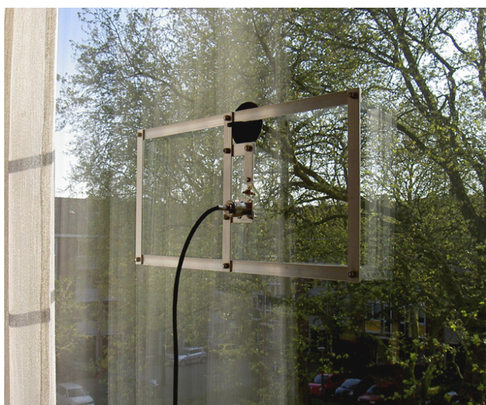
Antenne met zuignap aan het raam bevestigd
